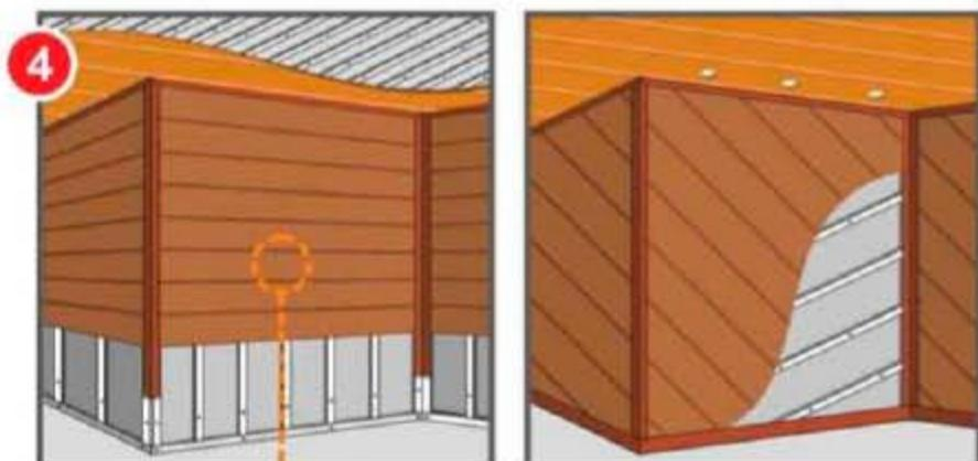
Pasang **DUMA® PANEL** dalam keadaan menyilang dengan rangka. Pemasangan dilakukan secara berurutan dari salah satu ujung ke ujung yang lainnya atau dari tengah menuju ke dua sisi lainnya dengan sekrup kepala datar.
