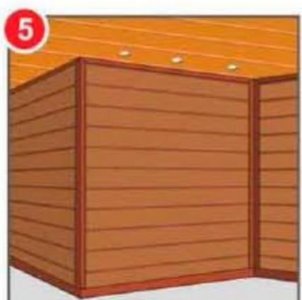
Pasang Lis Profil dengan lem PVC & **sekrup kepala datar** setelah seluruh area plafon atau dinding tertutup dengan **DUMA® PANEL**.
