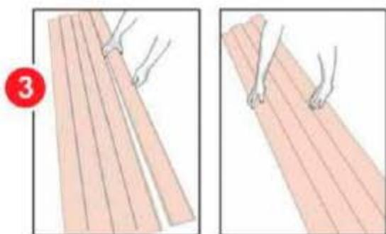
Simulasikan lonjoran **DUMA® PANEL** di permukaan yang rata, untuk menentukan urutan pemasangan.
