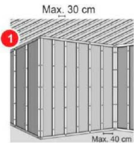
Persiapkan kerangka plafon atau dinding yang akan ditutup oleh **DUMA® PANEL**. Gunakan rangka dari bahan metal/rangka hollow ukuran 4x4 cm dengan jarak antar rangka:
